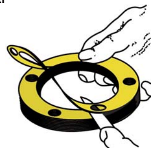
Sfogliatura con lama per gli spessori metallici
